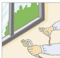
2 打開箱蓋拿出快速D型扣環扣入固定吊環內。
